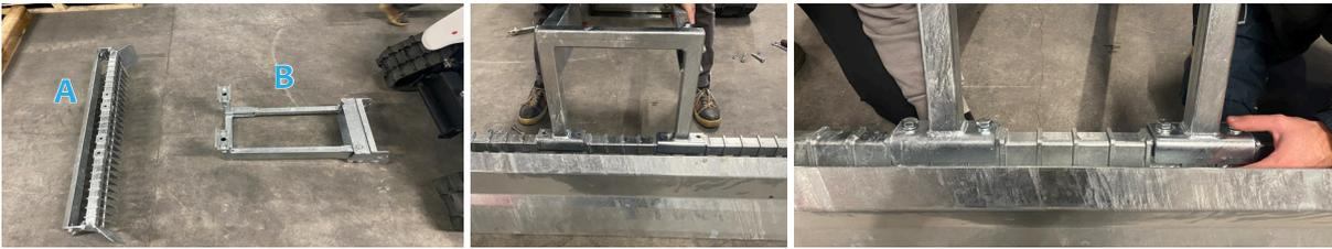
2- Mettre l'assemblage en face de la fixation du xbot. La fixation doit être en position haute.
