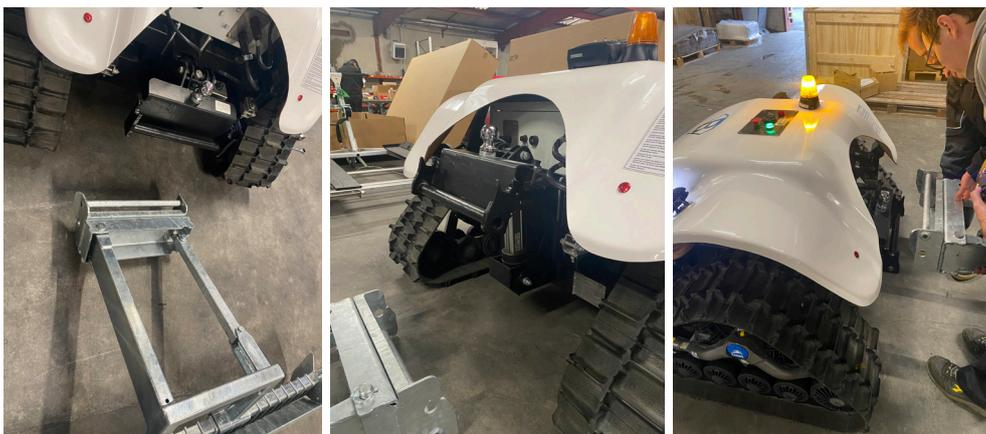
3- Usando il telecomando, fare indietreggiare l'X-Bot fino a poter agganciare il rastrello nell'asse superiore del dispositivo di fissaggio. Fare passare l'asse C tra il rastrello e il dispositivo di fissaggio dell'X-Bot, poi fissarlo con il perno.
