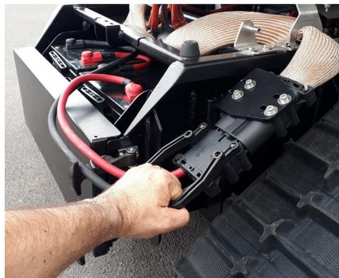
2. Collegare il connettore del caricabatteria alle batterie.
