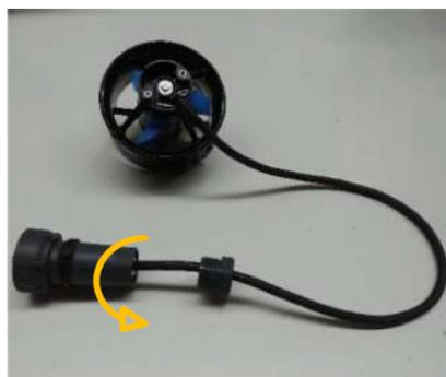
**ÉTAPE 3 :** utiliser l'outil de retrait de bouchon pour retirer l'enveloppe extérieure du module intérieur. Pousser l'outil à fond et le serrer tout en tirant la coquille vers le bas du fil. Cela peut demander un peu d'entraînement.
