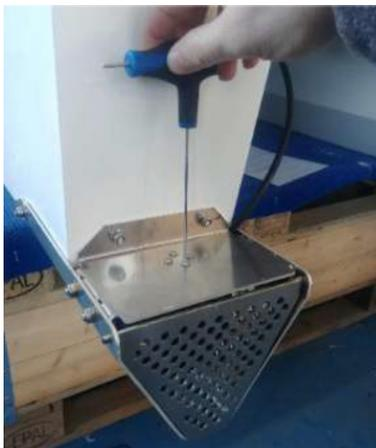
**ÉTAPE 7 :** tirer le câble à travers le trou de la protection du propulseur pour retirer complètement le propulseur.
