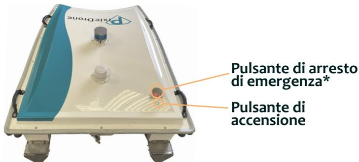
\* La forma e la posizione del propulsore e del pulsante di arresto di emergenza possono variare.
