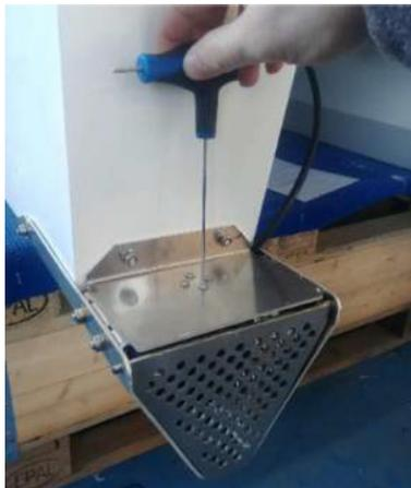
**FASE 7:** tirare il cavo attraverso il foro nel carter del propulsore per rimuovere completamente il propulsore
