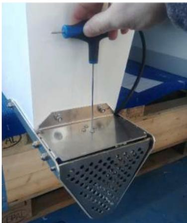
**FASE 7:** tirare il cavo attraverso il foro nel carter del propulsore per rimuovere completamente il propulsore
